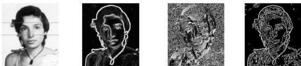
original image edge magnitude edge orientation edge map
